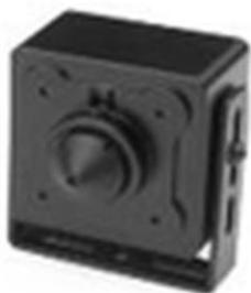
Telecamera IP miniaturizzata da interno con sensore CMOS progressivo 1/2.7" da 2Mp, risoluzione 1080p con 25Fps, ottica fissa pinhole da 2.8mm, luminosità 0.007Lux f2.4, porta LAN 10/100, 1 ingresso e 1 uscita audio, privacy mask 4 aree, 3D, WDR (120dB), alimentazione 12Vdc <1.5W, in dotazione staffa di fissaggio
