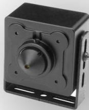
Telecamera HDCVI da interno con sensore CMOS progressivo 1/3" Aptina, risoluzione 1.4Mp con 50Fps, ottica fissa pinhole da 3.7mm conico, luminosità 0.01Lux f1.2, 2D, uscita video HD-CVI, OSD su cavo coassiale, alimentazione 12Vdc <120mA
