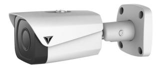
IR camera HDCVI da esterno/interno IP67, sensore progressivo 1/3" CMOS da 4.1Mp, risoluzione 2K con 25Fps o 1080p a 25Fps, ICR meccanico, ottica fissa 3.6mm, luminosità 0.01Lux f1.5 (0 con IR led ON), led IR portata fino a 40mt, 2/3D, WDR (120db), 2 uscite video (1 HDCVI e 1 CVBS), OSD su coassiale, alimentazione 12 Vdc <5.9W
