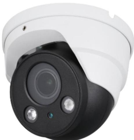
IR dome Eyeball IP H265 da esterno/interno IP67, sensore CMOS progressivo 1/3" progressive CMOS, risoluzione 4Mp con 20Fps, ICR meccanico, ottica motorizzata 2.7~13.5mm f1.4, luminosità 0.03Lux f1.4 (0 con Led ON), portata led IR fino a 50mt, 1 LAN 10/100Mbps, WDR (120db), 3DNR, slot per microSD card fino a 128 GB, alimentazione 12Vdc o PoE <9.5W
