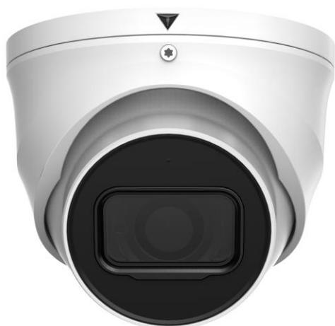
IR dome HDCVI Eyeball da esterno/interno IP67, sensore CMOS progressivo 1/2", risoluzione 4K con 15Fps o 6MP con 20Fps, ICR meccanico, ottica fissa 2.8mm f1.6, luminosità 0.005Lux (0Lux con IR On) con tecnologia Starlight, portata Led IR fino a 50 mt, 2/3D, WDR (120dB), 1 uscita video (HDCVI o CVBS con DIP switch), 1 ingresso audio con microfono incorporato, OSD, alimentazione 12Vdc <8W
