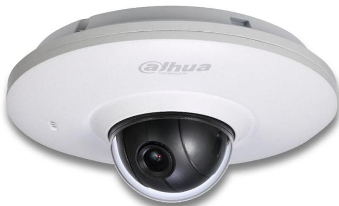
PT dome camera IP Eco Savvy motorizzata da esterno/interno IP66 con sensore CMOS progressivo 1/3", risoluzione massima 3Mp con 20Fps, rotazione PAN 180° (0.1°~100°/s) / TILT 0°~90° (0.1°~100°/s), ottica da 3.6mm con regolazione su 2 assi, luminosità 0.01Lux f1.2, capsula microfonica integrata, porta LAN 10/100Mbps, privacy mask 4 aree, 3D, D-WDR, alimentazione 12Vdc o PoE IEEE802.3af massimo 4.5W, dotazione software PSS e DMSS, compatibile con analisi video Videotrend
