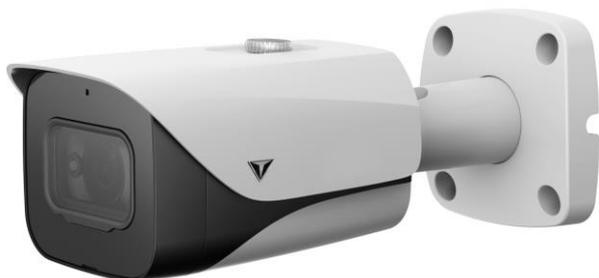
IR camera HDCVI da esterno/interno IP67 con sensore progressivo 1/2" CMOS da 8Mp, risoluzione 4K con 15fps, ICR meccanico, ottica 3.6mm, luminosità 0.005Lux f1.6 (0 con LED ON) con tecnologia Starlight, portata led IR fino a 40mt, 2/3D, WDR (120db), 1 uscita video (HD-CVI o CVBS), 1 ingresso audio con microfono integrato, OSD su cavo coassiale, alimentazione 12Vdc <6.8W
