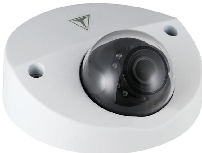
IR dome HDCVI da esterno/interno IP67 antivandalo IK10 con sensore progressivo 1/2.8" CMOS da 2Mp, risoluzione 1080p con 25fps, ICR meccanico, ottica fissa 2.8mm F1.6, luminosità 0.004Lux F1.6 (0 con IR On) con tecnologia Starlight, portata Led IR fino a 20 mt, 2/3D, 1 uscita video (HDCVI o CVBS con DIP switch), 1 ingresso audio + microfono incorporato, OSD, alimentazione 12Vdc <3.6W
