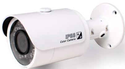
IR camera HDCVI da esterno/interno IP66 con sensore CMOS progressivo 1/3" Aptina, risoluzione 2Mp con 50Fps, ICR meccanico, ottica 3.6mm passo M12, luminosità 0.05Lux (0 con LED ON), led IR portata fino a 20mt, 2-3D, uscita video HD-CVI o PAL, OSD su cavo coassiale, alimentazione 12Vdc <350mA, in dotazione staffa di fissaggio
