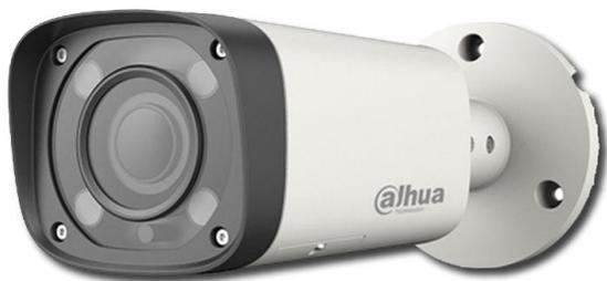
IR camera HDCVI da esterno/interno IP67, sensore progressivo 1/3" CMOS da 4Mp, risoluzione 4Mp con 15Fps o 1.080p con 25Fps, ICR meccanico, ottica motorizzata 2.7~12mm, luminosità 0.03Lux  $f$ 1.4 (0 con IR led ON), led IR portata fino a 60mt, 2-3D, WDR (120db), 1 uscita video (1 HDCVI o 1 CVBS), OSD su coassiale, alimentazione 12Vdc <11W
