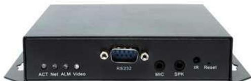
Encoder IP web browser 4 canali, rapporto risoluzione \ frame rate variabile, 4 ingressi e 2 uscite di allarme, 1 uscita video (BNC), 4 ingressi e 2 uscite audio bidirezionale, 1 slot SD Card per brevi backup, 1 LAN 10/100Mbps, RS485, alimentazione esterna a 12Vdc massimo 5W
