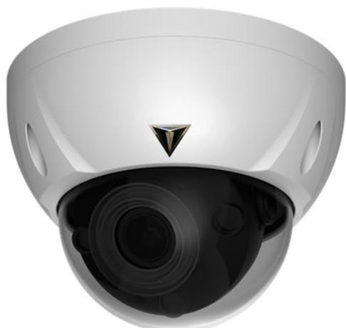
IR dome HDCVI da esterno/interno IP67 antivandalo IK10, sensore progressivo 1/2" CMOS da 8Mp, risoluzione 4K con 12.5Fps o 4MP con 25Fps, ICR meccanico, ottica 3.7~11mm *f*1.5 motorizzata, rotazione PAN 0°~355° / TILT 0°~65°, luminosità 0.01Lux *f*1.5 (0 con LED ON) con tecnologia Starlight, portata led IR fino a 50mt, 2/3D, WDR (120db), 2 uscite video (1 HDCVI 4K + 1 CVBS), 2 ingressi e 1 uscita di allarme, 1 ingresso audio, OSD su cavo coassiale, alimentazione 12Vdc / 24Vac <12.4W
