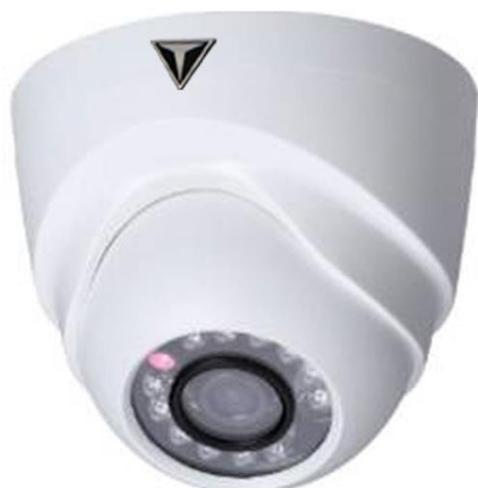
IR camera IP Eco Savvy II da esterno/interno IP67, sensore CMOS progressivo 1/3", risoluzione 4Mp con 20Fps, ICR meccanico, ottica fissa 2.8mm f2.0, luminosità 0.1Lux f2.0 (0 con Led ON), led IR portata fino a 30mt, 1 LAN 10/100Mbps, privacy mask 4 aree, 3D, D-WDR, face detection, alimentazione 12 Vdc/PoE <6.4W
